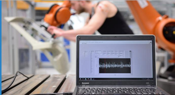
**BILD** *Bewertung der Ergonomie über Elektromyographie: Messung der Muskelaktivität bei MRK-Prozessen*
